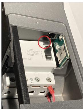
Figure 5 : Bouton de test RCD
